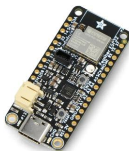
Figura 2.3: O microcontrolador ESP32 S2 WROOM é o coração do projeto.
