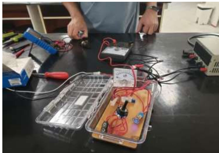
Figura 40. Testes de bancada para a determinação da resistividade do ferro fundido nodular.
