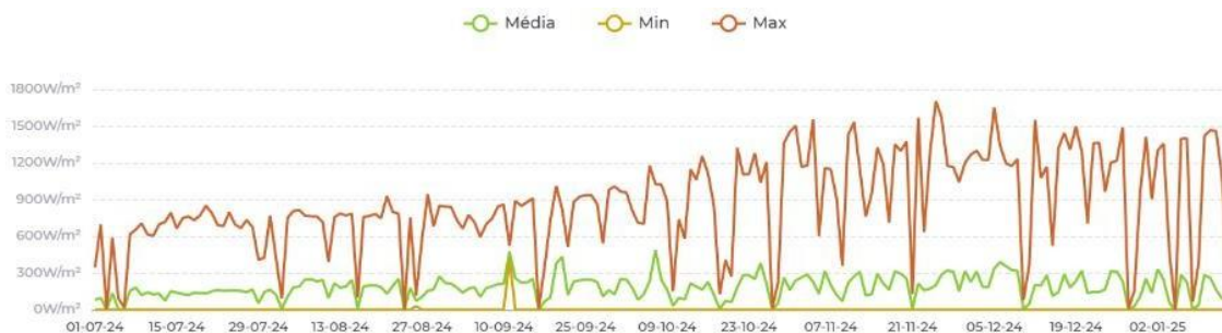
Figura 21- Gráfico gerado a partir do levantamento de dados climáticos em microestação meteorológica instalada no Campelo no período julho de 2024 a janeiro de 2025, a radiação solar em watts por metro quadrado.
