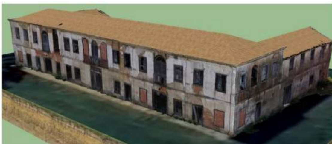
Imagem 17: Modelo 3d do Solar dos Airizes, obtido a partir da fotogrametria.
