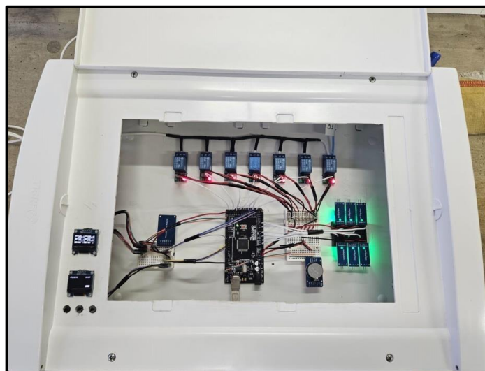
Figura 5: Sistema eletrônico inicial responsável pelo controle de irrigação.
