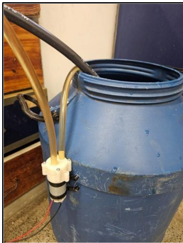
Figura 9: Bomba de aquário sendo testada junto a tanque d'água.
