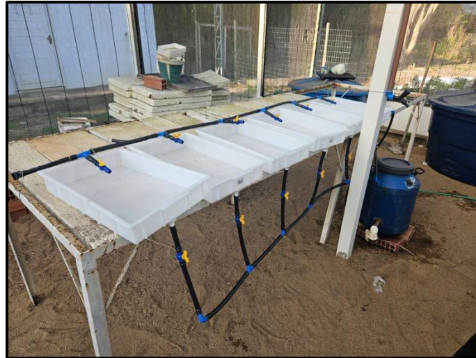
Figura 4: Estrutura do Sistema de irrigação “ebb and flow” que será usado para o experimento
