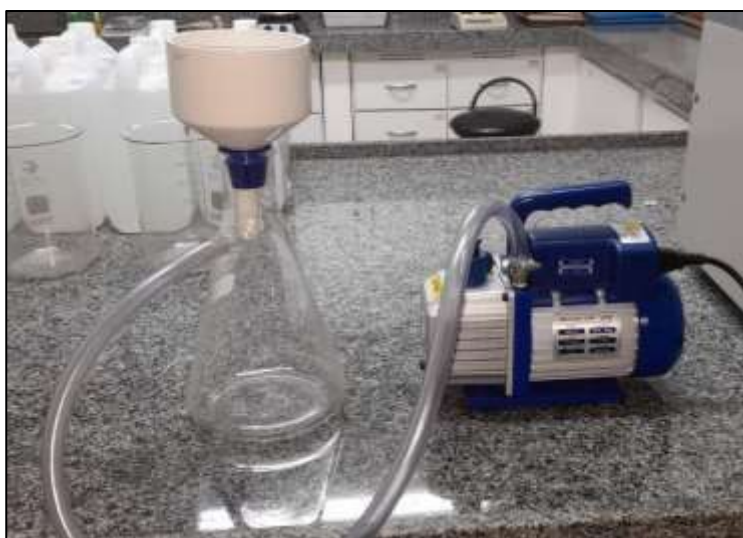
Figura 1. Bomba à vácuo utilizada na pré-filtração e filtração da água.
