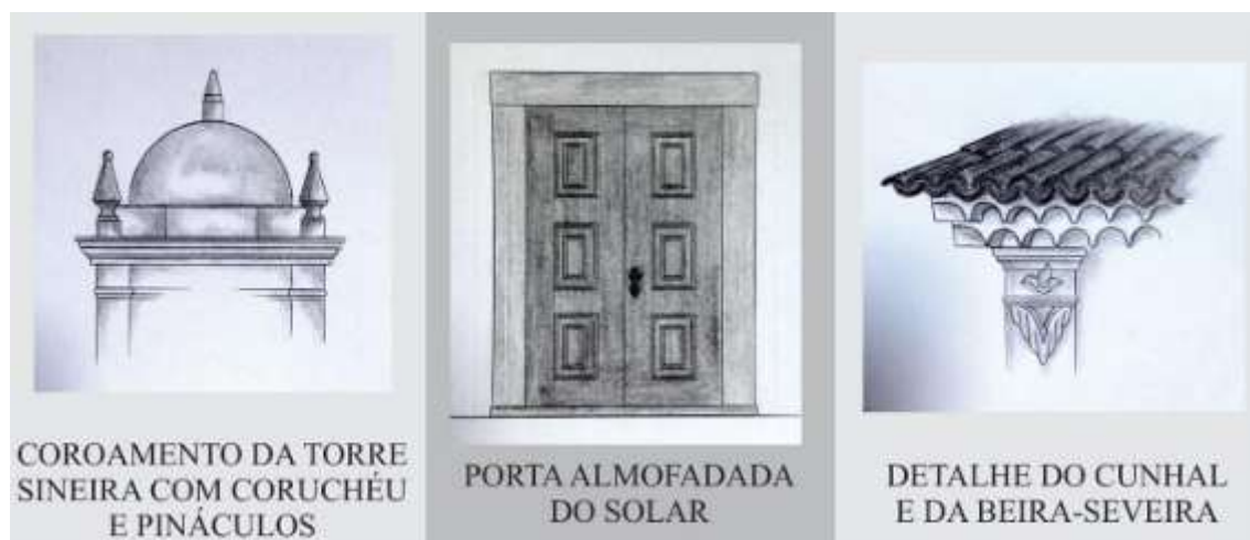
Figura 4 - Detalhes construtivos do Solar do Colégio.
